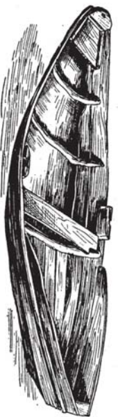
Рис. 105. Челнок-ботник полудолбленный, борта с набойными досками. Начало XX века.
